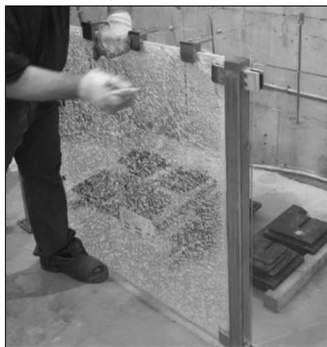
Foto 2 - a sinistra: la ringhiera durante l'esecuzione della prova allo SLU (3 kN/m).
